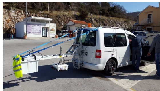
Slika 3: Sustav Hi-Pave s dvije antene montiran na vozilo
