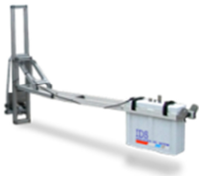
Slika 1: Metalni nosač i antena HORN
